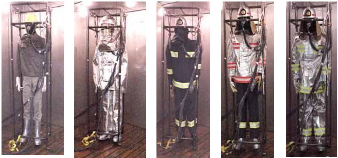
サーマルマネキンによる実験に使用した作業服（左端）と消防員装具
